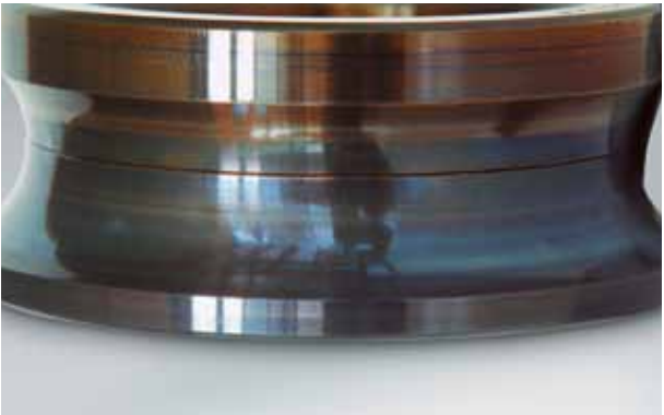
Foto 18.2 Bauteil: Innenring eines Vierpunktkugellagers Symptom: Blau- oder Lilafärbung der Laufbahn Ursache: Wärmeentwicklung aufgrund von Mangelschmierung
