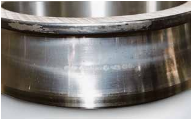
Foto 2.1 Bauteil: Innenring eines Pendelrollenlagers Symptom: Runde Aufrauung in der Mitte der Laufbahn Ursache: Mangelschmierung
