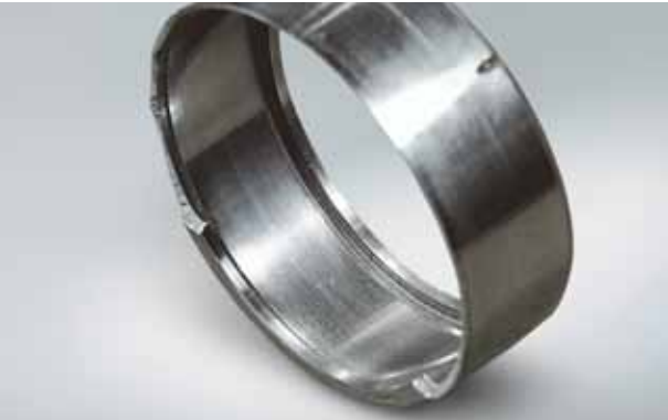
Foto 5.4 Bauteil: Außenring eines Nadelrollers Symptom: Bruch des Außenringbords Ursache: Schränken der Rolle aufgrund übermäßiger Belastung (Nadelrollen sind im Verhältnis zu ihrem Durchmesser sehr lang. Bei übermäßiger oder ungleichmäßiger Belastung schränken die Rollen und drücken gegen die Borde.)
