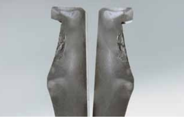
Foto 6.7 Bauteil: Querschnitt des gerissenen Innenrings auf Foto 6.6 Symptom: Riss entsteht unmittelbar unterhalb der Laufbahn
