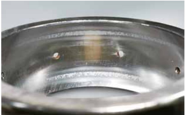
Foto 2.4 Bauteil: Außenring eines Pendelrollenlagers Symptom: Aufrauungen nahe der Laufbahnschulter am gesamten Umfang Ursache: Mangelschmierung
