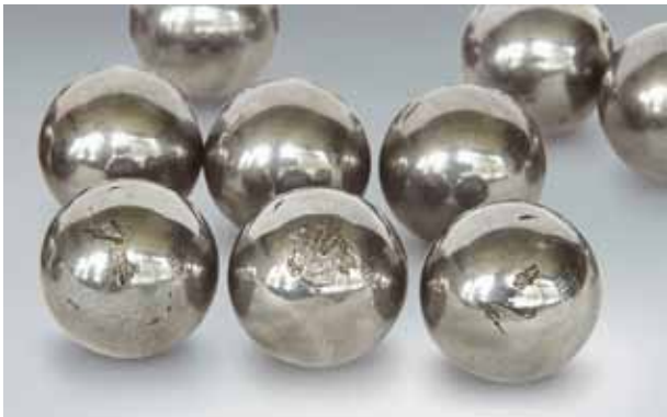
Foto 1.6 Bauteil: Kugeln zu Foto 1.4 Symptom: Abblätterung der Kugeloberfläche Ursache: Eindrücke durch Stoßbelastung im Stillstand
