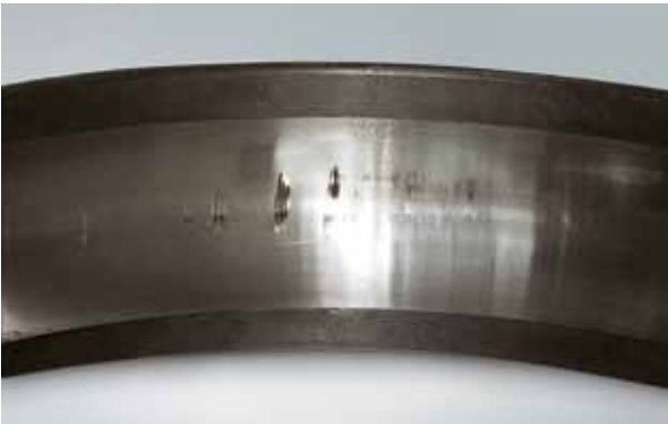
Foto 12.2 Bauteil: Außenring zu Foto 12.1 Symptom: Stillstandsmarkierung an der Laufbahn Ursache: Schwingungen von außen im Stillstand
