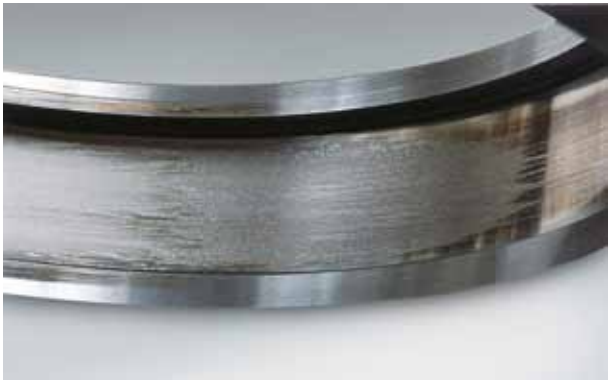
Foto 4.2 Bauteil: Außenring zu Foto 4.1 Symptom: Anschmierungen am Umfang der Laufbahn Ursache: Rollenschlupf durch zu hohe Fettfüllung
