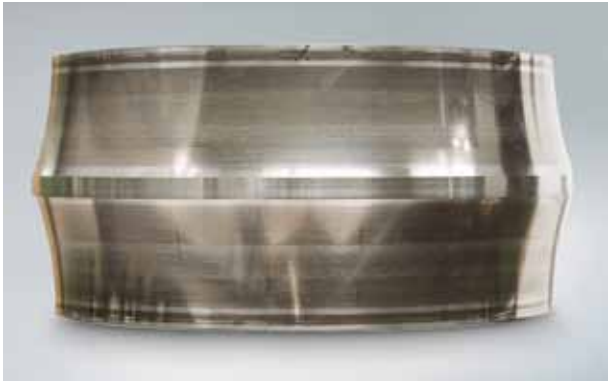
Foto 4.3 Bauteil: Innenring eines Pendelrollenlagers Symptom: Anschmierungen am Umfang der Laufbahn Ursache: Mangelschmierung
