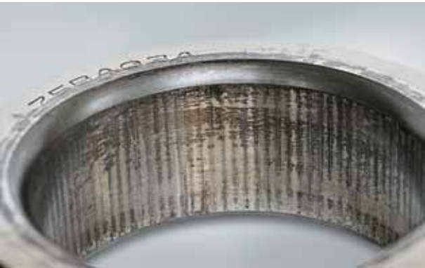
Foto 11.2 Bauteil: Innenring eines Schrägkugellagers Symptom: Starker Passungsrost am gesamten Umfang der Bohrungsfläche Ursache: Unzureichende Passung
