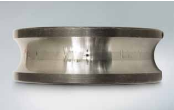
Foto 12.1 Bauteil: Innenring eines Rillenkugellagers Symptom: Stillstandsmarkierung an der Laufbahn Ursache: Schwingungen von außen im Stillstand
