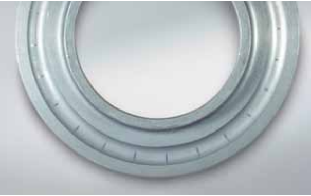
Foto 12.3 Bauteil: Außenring eines Axial-Rillenkugellagers Symptom: Stillstandsmarkierung an der Laufbahn im Wälzkörperabstand Ursache: Kurze, sich wiederholende Schwingungen
