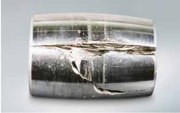
Foto 6.8 Bauteil: Rolle eines Pendelrollenlagers Symptom: Axiale Risse in der Lauffläche
