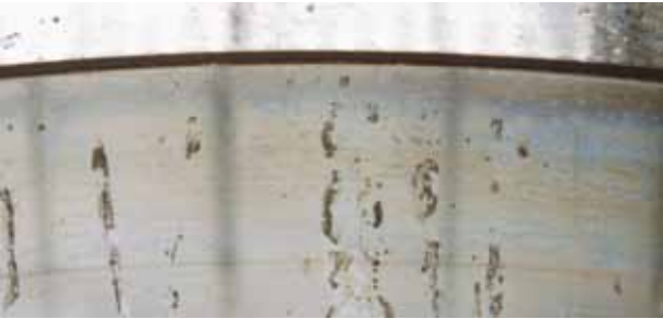
Foto 16.3 Bauteil: Innenring eines Pendelrollenlagers Symptom: Rost in der Laufbahn im Wälzkörperabstand Ursache: Wasser im Schmiermittel
