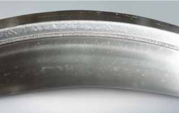
Foto 3.1 Bauteil: Innenring eines Pendelrollenlagers Symptom: Riefen auf der Seite des großen Bords des Innenrings Ursache: Rollenschlupf durch starke Beschleunigung und Verzögerung
