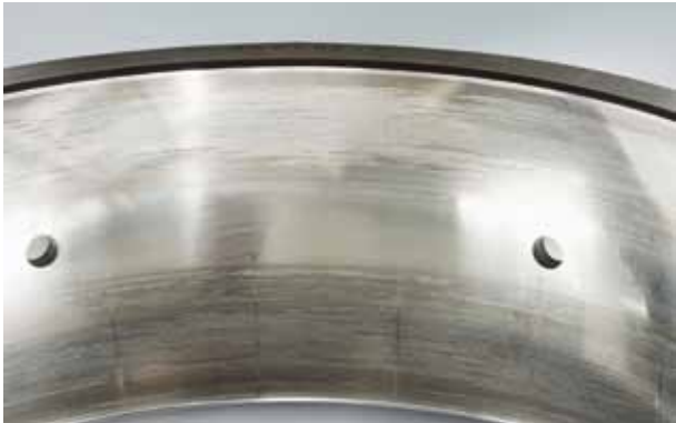
Foto 4.4 Bauteil: Außenring zu Foto 4.3 Symptom: Anschmierungen am Umfang der Laufbahn Ursache: Mangelschmierung
