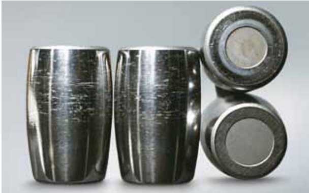
Foto 3.2 Bauteil: Wälzkörper zu Foto 3.1 Symptom: Riefen an der Stirnfläche der Wälzkörper Ursache: Rollenschlupf durch starke Beschleunigung und Verzögerung
