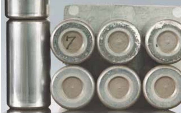
Foto 3.4 Bauteil: Rollen eines zweireihigen Zylinderrollenlagers Symptom: Riefen in der Stirnfläche der Wälzkörper Ursache: Mangelschmierung und übermäßige Axialbelastung
