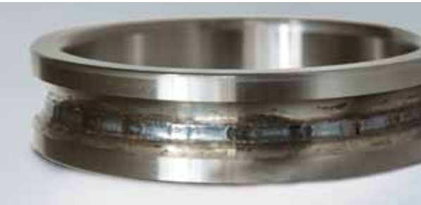
Foto 14.3 Bauteil: Innenring eines Schrägkugellagers Symptom: Verfärbung der Laufbahn, Verschmelzung im Wälzkörperabstand Ursache: Zu große Vorspannung
