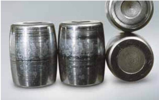
Foto 2.3 Bauteil: Wälzkörper zu Foto 2.1 Symptom: Runde Aufrauung in der Mitte der Laufflächen Ursache: Mangelschmierung
