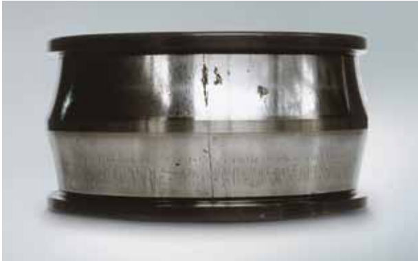
Foto 6.6 Bauteil: Innenring eines Pendelrollenlagers Symptom: Axiale Risse in der Laufbahn Ursache: Zu starke Passung durch Temperaturunterschiede zwischen Welle und Innenring
