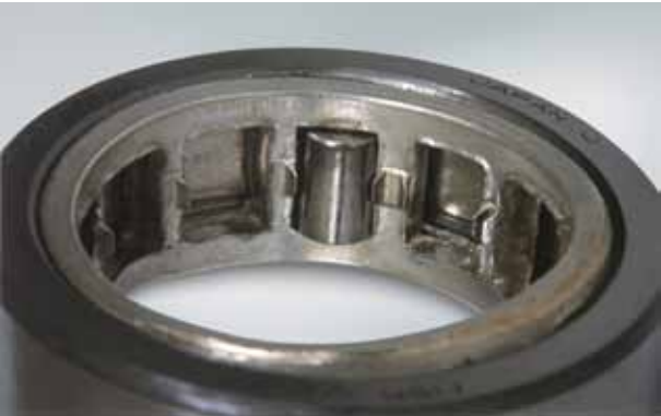
Foto 7.7 Bauteil: Käfig eines Zylinderrollenlagers Symptom: Verformung und Verschleiß des Messingmassivkäfigs
