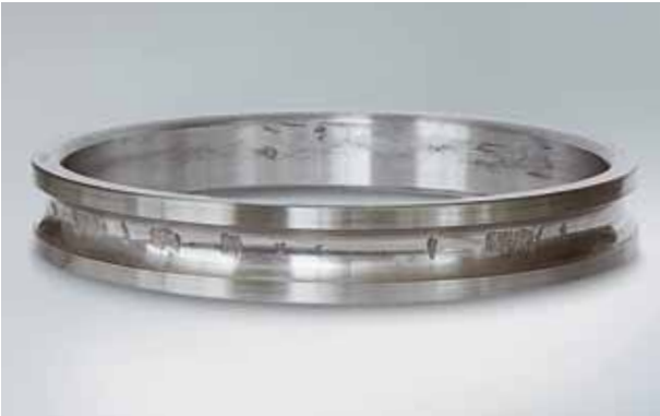
Foto 1.4 Bauteil: Innenring eines Schrägkugellagers Symptom: Abblätterung der Laufbahn im Kugelabstand Ursache: Eindrücke durch Stoßbelastung im Stillstand
