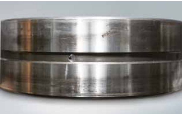
Foto 13.2 Bauteil: Außenring eines Pendelrollenlagers Symptom: Kriechen entlang des gesamten Umfangs der Außenfläche Ursache: Lose Passung zwischen Außenring und Gehäuse
