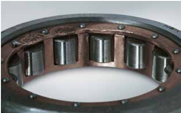
Foto 7.6 Bauteil: Käfig eines Zylinderrollenlagers Symptom: Verformte Käfigscheiben eines Messingmassivkäfigs Ursache: Starke Stoßbelastung während der Montage
