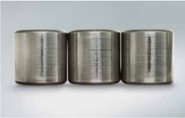
Foto 12.4 Bauteil: Rollen eines Zylinderrollenlagers Symptom: Stillstandsmarkierung an der Lauffläche Ursache: Schwingungen von außen im Stillstand
