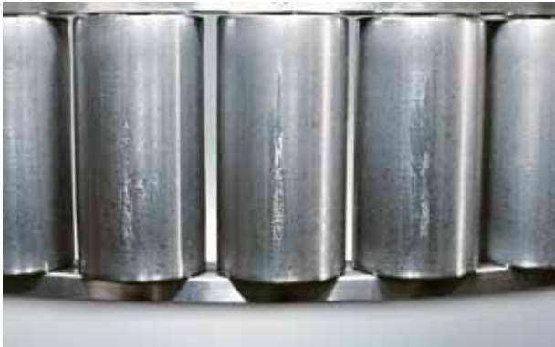
Foto 1.10 Bauteil: Rollen eines Zylinderrollenlagers Symptom: Vorzeitige Abblätterung in axialer Richtung auf der Mantelfläche Ursache: Schürfmärken durch unsachgemäße Montage
