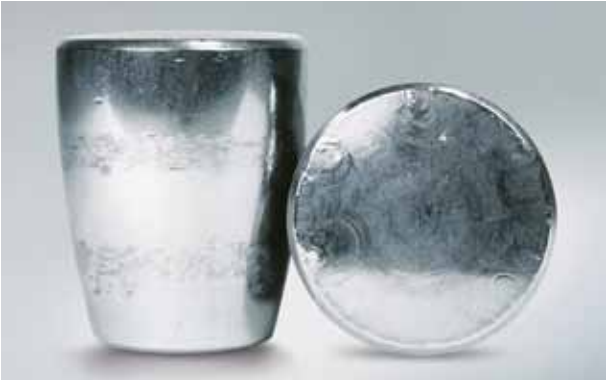
Foto 3.6 Bauteil: Wälzkörper zu Foto 3.5 Symptom: Riefen in der Stirnfläche der Wälzkörper Ursache: Eindruck von Fremdkörpern in der Oberfläche und übermäßige Axialbelastung
