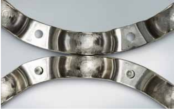
Foto 3.7 Bauteil: Käfig eines Rillenkugellagers Symptom: Riefen in den Taschen des Stahlblechkäfigs Ursache: Eindringen von Fremdkörpern
