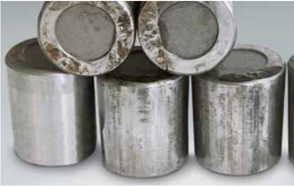
Foto 10.4 Bauteil: Kegelrollen zu Foto 10.3 Symptom: Stufenförmige Abnutzung an den Stirnflächen der Rollen Ursache: Fortschreitendes Fressen durch übermäßige Belastung im Stillstand
