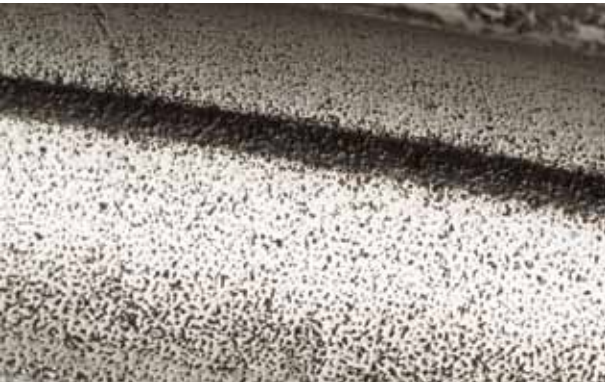
Foto 9.1 Bauteil: Außenring eines Schwenklagers Symptom: Pitting an der Laufbahn Ursache: Rostspuren in den Eindrücken
