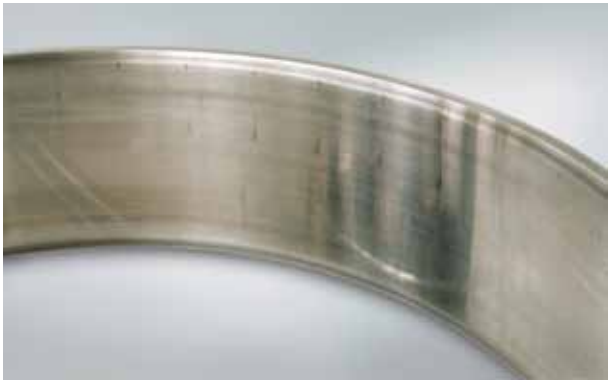
Foto 17.2 Bauteil: Außenring eines zweireihigen Zylinderrollenlagers Symptom: Achsparallele Riefen im Wälzkörperabstand in der Laufbahn Ursache: Fluchtungsfehler zwischen Innen- und Außenring bei der Montage
