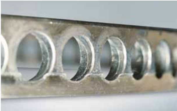
Foto 7.8 Bauteil: Käfig eines Schrägkugellagers Symptom: Stufenförmige Abnutzung an der Mantelfläche und der Taschenfläche des Messingmassivkäfigs
