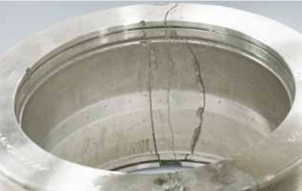
Foto 6.5 Bauteil: Laufbahn des Außenrings auf Foto 6.4 Symptom: Riss in der Außenfläche, der sich zur Laufbahn ausbreitet
