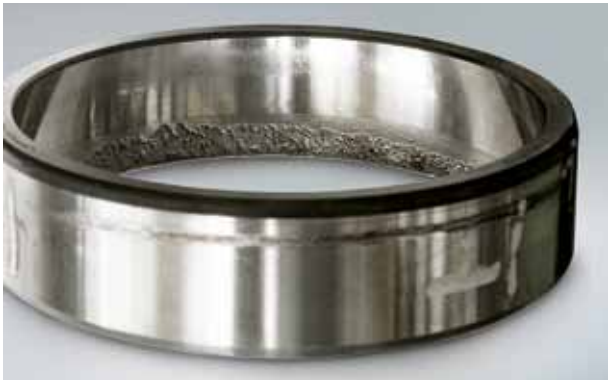
Foto 1.8 Bauteil: Außenring zu Foto 1.7 Symptom: Abblätterung an nur einer Laufbahn am gesamten Umfang Ursache: Übermäßige Axialbelastung
