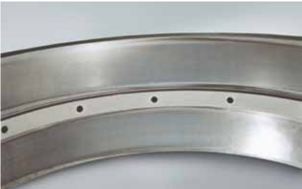
Foto 8.2 Bauteil: Außenring eines zweireihigen Kegelrollenlagers Symptom: Eindrücke in der Laufbahn Ursache: Fremdkörper in die Oberfläche eingedrückt
