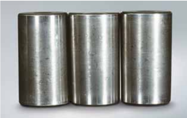
Foto 8.4 Bauteil: Kegelrollen zu Foto 8.3 Symptom: Kleine und große Eindrücke entlang der Lauffläche Ursache: Fremdkörper in die Oberfläche eingedrückt
