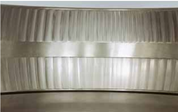
Foto 10.2 Bauteil: Außenring eines Pendelrollenlagers Symptom: Abnutzung der Laufbahn mit einer welligen oder konkav-konvexen Struktur in der Lastzone Ursache: Eindringen von Fremdkörpern bei wiederholten Schwingungen im Stillstand
