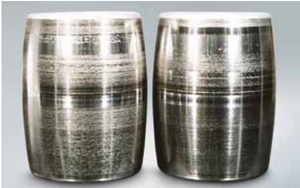
Foto 4.7 Bauteil: Wälzkörper zu Foto 4.5 Symptom: Anschmierungen an Laufflächen Ursache: Mangelschmierung
