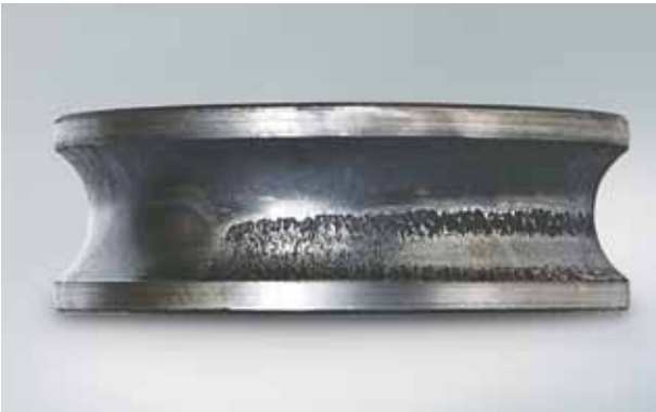
Foto 1.2 Bauteil: Innenring eines Schrägkugellagers Symptom: Diagonale Abblätterung entlang der Laufbahn Ursache: Fluchtungsfehler zwischen Welle und Gehäuse während des Einbaus
