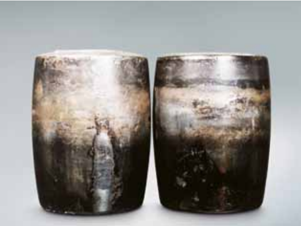
Foto 14.2 Bauteil: Wälzkörper zu Foto 14.1 Symptom: Verfärbung und Schmelzen der Mantelfläche, Adhäsion von Verschleißpartikeln des Käfigs Ursache: Unzureichende Schmierung
