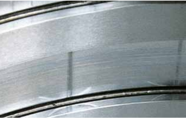
Foto 11.3 Bauteil: Außenring eines zweireihigen Zylinderrollenlagers Symptom: Passungsrost an der Laufbahn im Wälzkörperabstand
