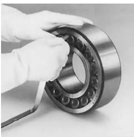
Abb. 1: Überprüfen der Lagerluft im ausgebauten Zustand
