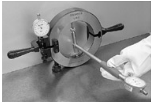
Abb. 1.11: Laufbahndurchmesser des Außenrings auf das GN-Hüllkreismessgerät übertragen
