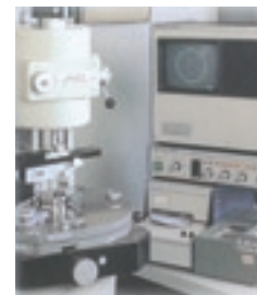
Rundheits- messgerät mit hoher Vergrößerung (200 000-fach)
