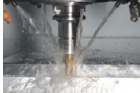
Fräser: Ø16 Werkstoff: A5052 Drehzahl: 20 000 min -1 2 500 cm 3 /min
