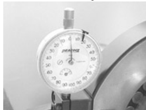
Abb. 1.15: Messen der erforderlichen Zwischenringbreite
