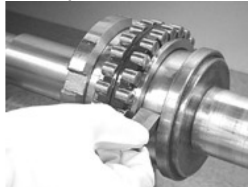
Abb. 1.15: Messen der erforderlichen Zwischenringbreite
