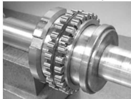
Abb. 1.13: Einstellen des GN-Hüllkreismessgeräts
