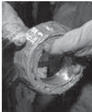
Abb. 23: Schmierfett kann einfach von Hand aufgetragen werden.
