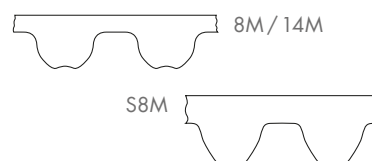
optibelt OMEGA High Load im Querschnitt
