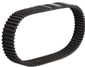
Doppelzahnriemen besitzen eine beidseitige Verzahnung und können von der Ober- sowie Unterseite die gesamte Antriebsleistung übertragen. Ihre Anwendung finden Sie hauptsächlich, um einen Drehrichtungsumkehr im Antrieb zu realisieren. Sie zeichnen sich neben einer hohen Leistungsübertragung durch einen ruhigen Lauf und einer große Flexibilität aus und können auf sehr kleine Riemenscheiben eingesetzt werden durch die hohe Biegewilligkeit.
